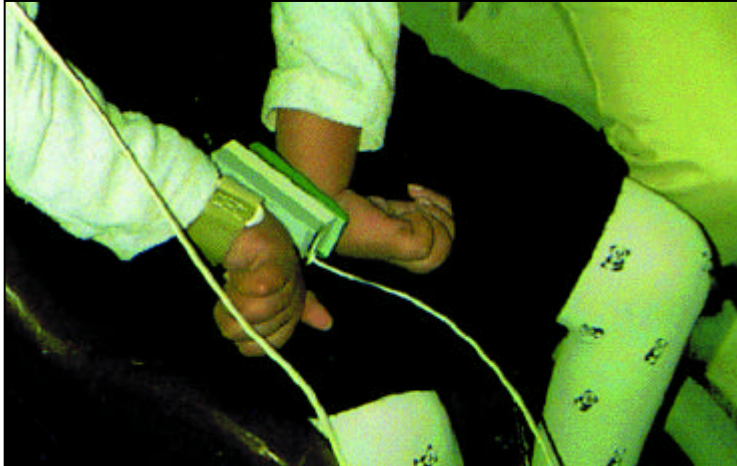
Acceso al teclado del ordenador mediante un conmutador sujeto con velcro y accionado con un ligero movimiento de muñeca.
