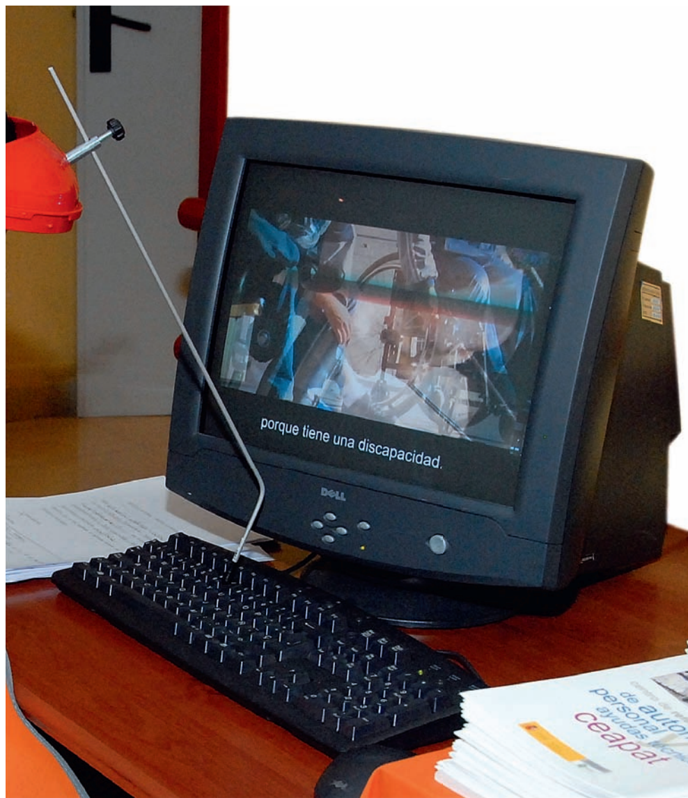
“puntómetro” de bajo coste, realizado en uno de los talleres en 15 minutos.
